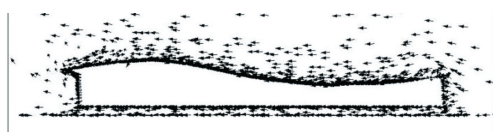
(a) 建筑模型对称面的速度矢量图( 160^\circ )
